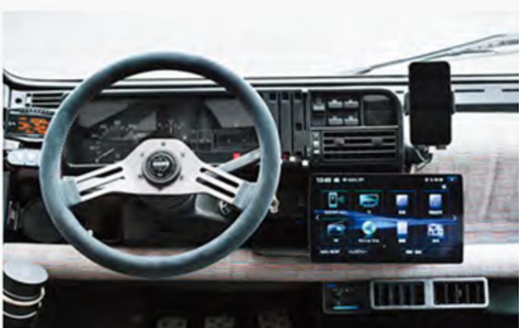
取り付けた車両は旧型の輸入車。装着適合は未確認のクルマながら、オウンリスクで装着した。もともと2DIN用にプラケットを製作しており、周囲のスペースにも主だった干渉物がなかったために取り付け可能と判断。付けてみるとなるほど、汎用性は高い。
