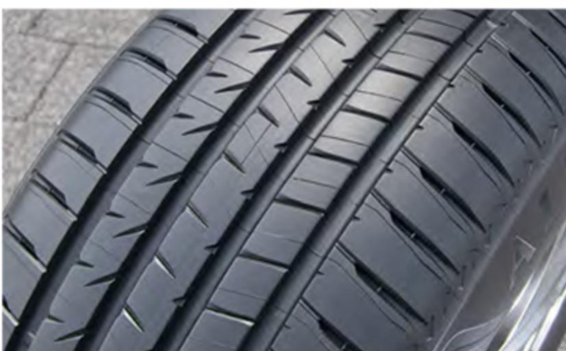
残り溝がないと、雨の日にスリップしやすくブレーキも効きにくくなる。残り溝は1.6mmないと車検にも通らない。ちなみに片減りしている場合もNG。残り溝のすべてが1.6mm以上必要だ。タイヤの溝には盛り上がった部分(スリップサイン)があるので、露呈していないか要チェックだ。
