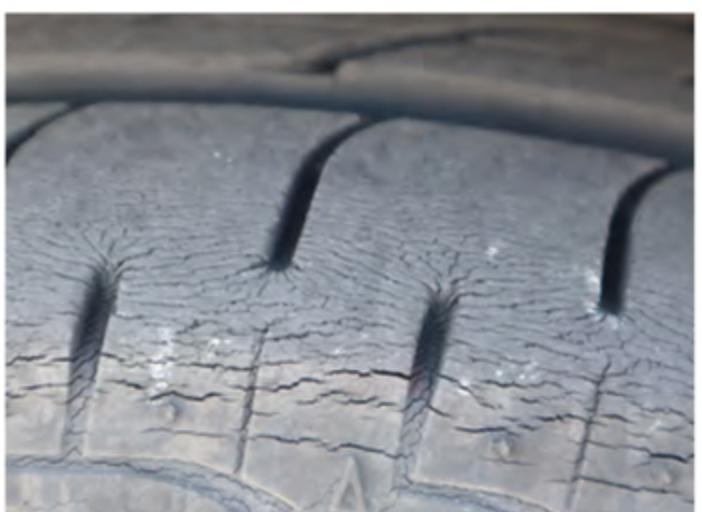
ゴムの硬化が進み、ひび割れが発生しているようなら危険。ゴムが経年劣化している証拠だ。また縁石にヒットするなどして亀裂しているケースも。バーストする危険があるので、すぐに新品タイヤに交換しよう。
