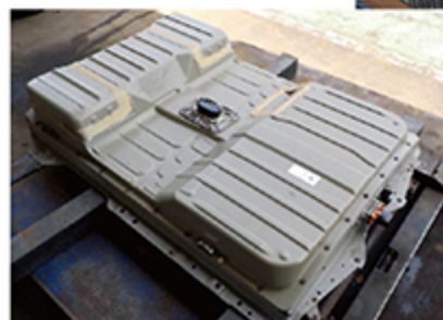
外したバッテリーケース。中期以降は周囲をシーリングされているため割がす工程が必要となる。
