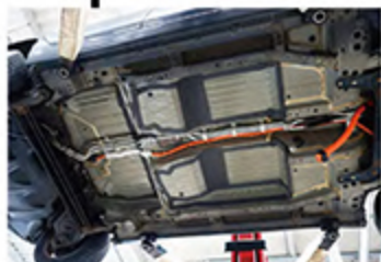
バッテリーがごとりと外された状態。降雪地域の車両 の場合は、ボルトとナットが固着している場合が多く と手間多くかかる。
