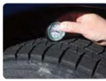
溝の深さは9mm。標準的な深さが確保されている。
